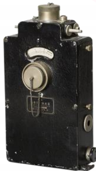
光学干涉式 气体检测仪 3型 (1939年)
